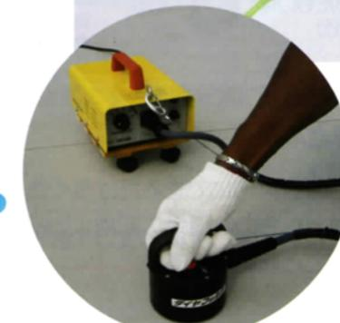
HF加熱装置による接合
