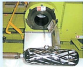
CFRP圧力容器のFW成形
